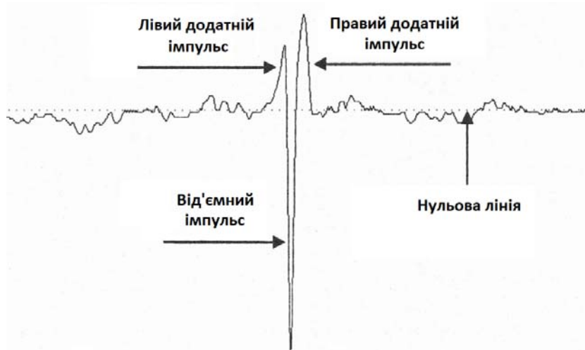
Рис. 2. Типова форма сигналу від дефекту по коду 21.
