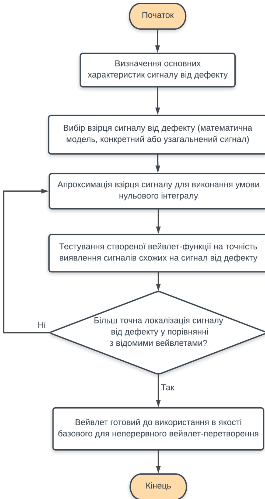
Рис. 4. Блок-схема алгоритму створення вейвлет-функції для НВП, адаптованої до виявлення сигналів від дефектів при магнітодинамічній діагностиці залізничних рейок.
